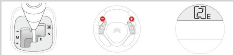
**Mode automatique (Easy) :** dirigez le levier de vitesse, en maintenant le pied sur la pédale de frein, vers l'arrière pour sélectionner la position **E**.
