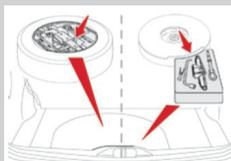
La roue de secours est installée dans le coffre sous le plancher. Vous y trouverez aussi une clé pour démonter la roue et le cric. Plus de détails dans le manuel d'instructions de la voiture.
