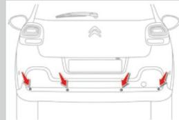
Cette voiture est équipée d'une aide au stationnement à l'arrière. L'information de proximité est donnée par un signal sonore discontinu dont la fréquence est d'autant plus rapide que le véhicule se rapproche d'un obstacle. Veillez à vous arrêter à temps !
