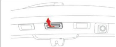
Après déverrouillage du véhicule à l'aide de la télécommande ou de la clé, tirez sur la poignée et soulevez la porte du coffre.
