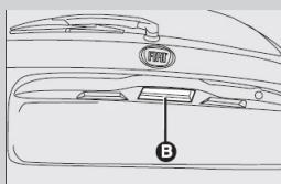
Il s'ouvre à l'aide de la télécommande de la clé. Vous pouvez également, lorsque la voiture est déverrouillée, ouvrir le coffre en utilisant la poignée **B**.
