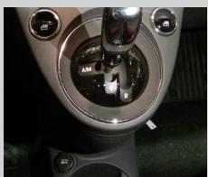
Si le levier est sur **N**, il faut appuyer sur le frein et remettre le levier en « vitesse » pour redémarrer.
