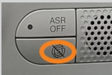
La fonction Start/Stop est activée par défaut après avoir roulé à un minimum de 10 km/h.
