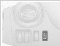
Le système s'enclenche automatiquement quand la marche arrière est engagée. Un bref signal sonore indique que le système est prêt à fonctionner.
