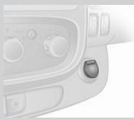
Il y a une prise 12V sur le tableau de bord et une à l'arrière du véhicule. Ôtez le bouchon pour y accéder.
