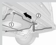
La roue de secours se trouve sous la voiture. Pour libérer le support de la roue de secours, desserrez la vis 1 sans l'enlever. Retirez la vis 2, puis tirez le support vers la gauche jusqu'à ce qu'il dégage la vis 1 et abaissez l'ensemble du support. Le cric et la clé se trouvent dans un coffre à outils sous le siège conducteur.
