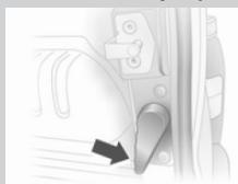
Tirez la poignée externe pour ouvrir la porte arrière gauche. La porte arrière droite s'ouvre à l'aide d'un levier à l'intérieur de celle-ci.
