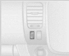
Le bouton pour activer le régulateur de vitesse se situe à gauche du volant sous la ventilation. Sur le volant le « + » et le « - » vous permettent d'augmenter ou de diminuer la vitesse.
