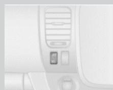
A gauche du volant sous la bouche d'aération se trouve un bouton pour allumer/éteindre le limiteur. C'est le même bouton que le régulateur. Avec + et - sur le volant vous pouvez toujours augmenter/diminuer la vitesse.
