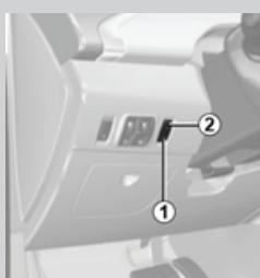
Les voitures électriques sont très silencieuses. Un système vous permet d'avertir les piétons et les cyclistes. Il est automatiquement enclenché lorsque la voiture roule à une vitesse comprise entre 1 et 30km/h.
