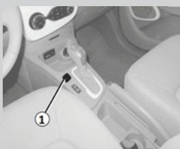
Le mode ECO est une fonction qui permet d'optimiser le rayon d'action de la voiture, mais elle a un impact sur la vitesse, l'accélération, le chauffage, etc. Si le mode ECO est activé, la partie inférieure du tableau de bord sera en vert. Pour activer ou désactiver le mode ECO, appuyez sur le bouton "ECO" (1) à côté du levier de vitesse.
