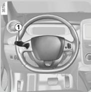
**Phares** : L'éclairage s'adapte **automatiquement à la luminosité extérieure** sans avoir à utiliser le sélecteur (1) qui se trouve à gauche du volant. Vérifiez que la commande soit bien active. Si ce n'est pas le cas, tournez la bague jusqu'à atteindre le symbole "Auto".
