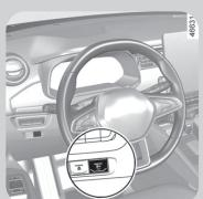
Les voitures électriques sont particulièrement silencieuses. Ce système alerte les piétons et cyclistes de votre présence. L'avertisseur sonore piéton fonctionne **dès la mise en mouvement du véhicule et jusqu'à 30km/h, en marche avant et arrière**.
