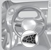
Vous pouvez activer/désactiver le régulateur de vitesse/cruise control à l'aide des boutons situés **sur le volant**, à gauche.
